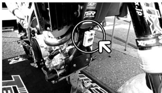
※マフラーの熱、走行中のストローク、転倒等で計測器が脱落しない様に注意して取り付けて下さい。
