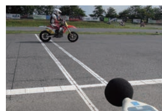
走行音量はコントロールライン脇にて測定(音量規定:99dB)
