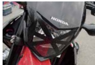
灯火類はビニールテープ等の有色の物でテーピング
