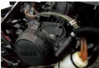
キャブレターのオーバーフローパイプはキャッチタンクへ
